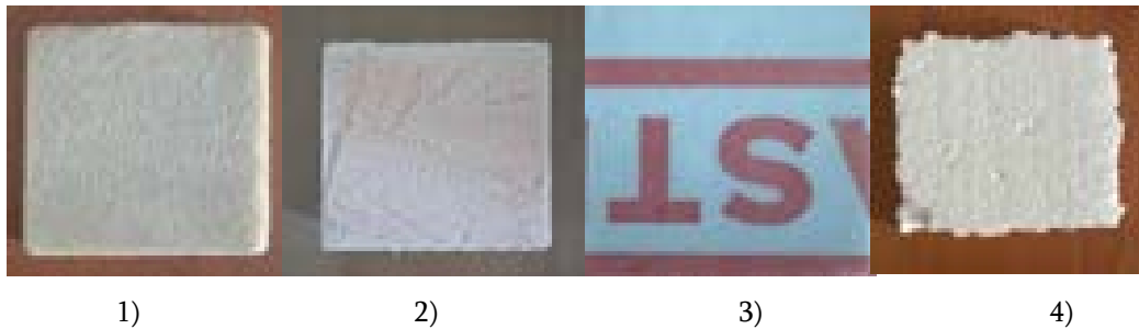
Նկ. 2. Մեկուսիչ նյութեր. 1- հանքային բամբակ, 2 - պենոպլեքս, 3 - էքստրուդացված պոլիստիրոլի փրփուր (XPS), 4 - փրփրապոլիստիրոլ (EPS)
