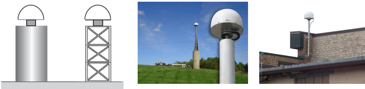
Նկ. 3. GPS ռեֆերենց ցանցի կայանների տեղադրման տեսակներ
