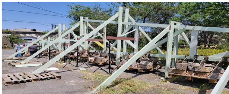
Նկ. 6. Ֆերմայի և չափիչ սարքավորումների տեսքը բեռնվածքի IV փուլի բեռնավորումից հետո
