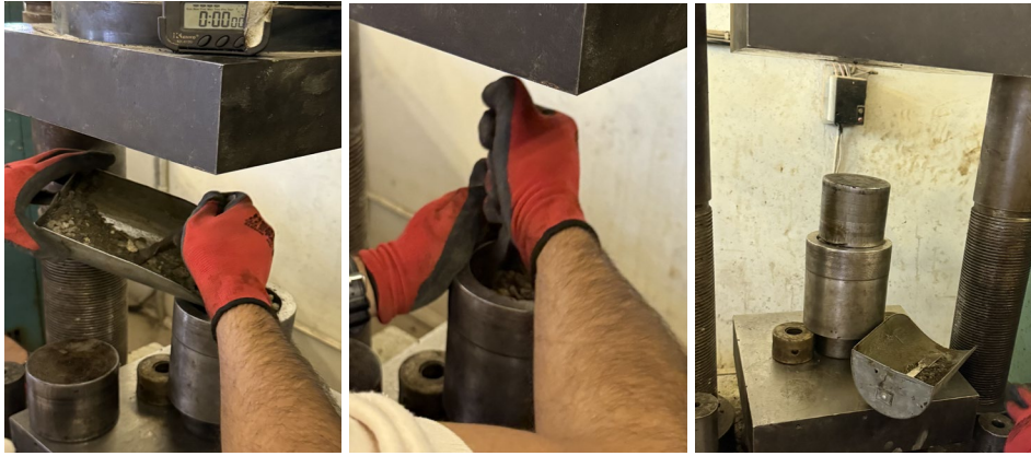
Նկ. 5. Աղացած ասֆալտրետտոնի խտացման աշխատանքներ
