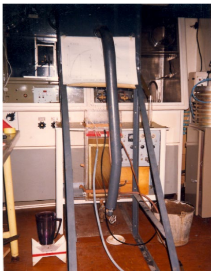
Рис. 2. Лабораторная установка тонкослойного отстаивания
