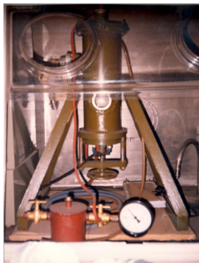
Рис. 3. Лабораторная установка напорной флотации
