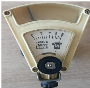
Նկ. 1. Միկրոավտոբուսի շարժման ժամանակ արագացումների չափման դեսելերումետր (դանդաղաչափիչ)
